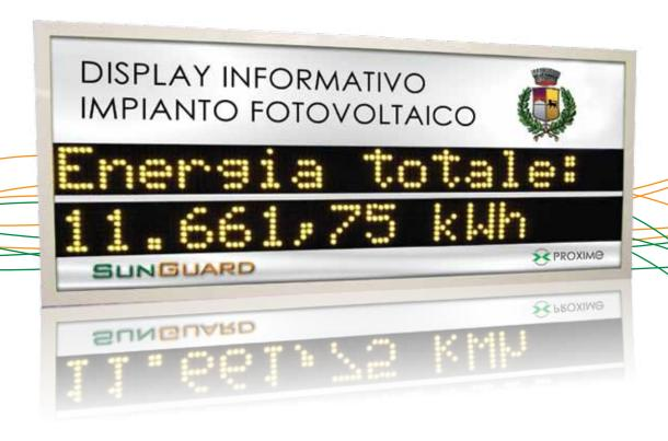
SunGuard Display a LED da esterno, connessione Web e seriale RS485, 32 caratteri alfanumerici, 15 Kg, 1500(b)x700(h)x75(p)mm. Variabili visualizzabili in modalità Web illimitate (in modalità RS485 sono: Energia totale, alberi risparmiati, Co2, potenza istantanea, barili di petrolio equivalenti). Escluso analizzatore di rete RS485.
